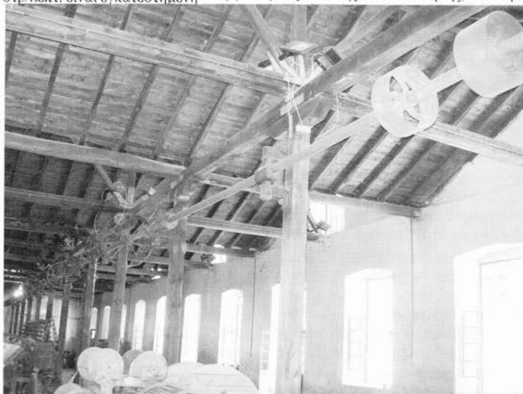
Ο κεντρικός άξονας μετάδοσης της κίνησης με τις κατάλληλες τροχαλίες
