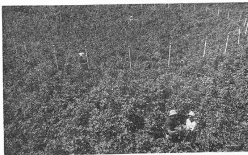
Ερευνητές στην Αριζόνα για να μελετήσουν την επίδραση του ατμοσφαιρικού διοξειδίου του άνθρακα στο βαμβάκι, χρησιμοποιούν κάθετους σωλήνες που εκτοξεύουν και εμπλουτίζουν με \text{CO}_2 μία έκταση με βαμβάκι περίπου μισό στρέμμα.
